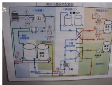
冷却負荷半減を可能にした 熱交換システム （模式図）
