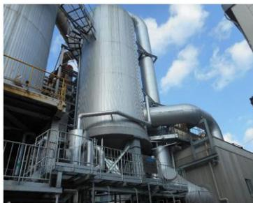
黒液濃縮装置(蒸気圧縮方式)
