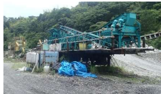
⑨ 2次破碎機に投入 (株)古川金属機械(株)製 移動式古川リプランF40TR型
