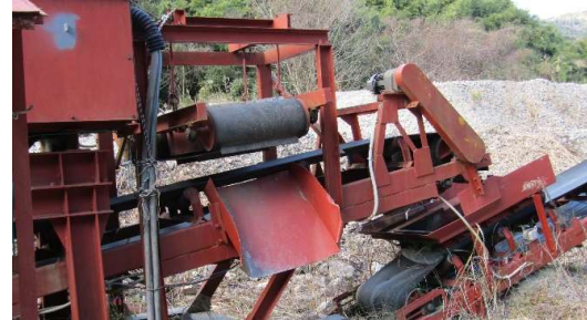
⑦ 破碎後に磁選機で鉄筋等の除去
