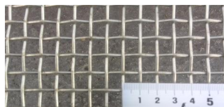
二次破碎チップを振り分け機（トロンメル）スクリーンφ10 mmにて選別を行う。
