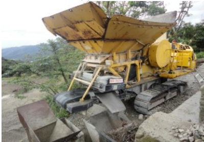
破砕機(BR100JG型)にて破砕
