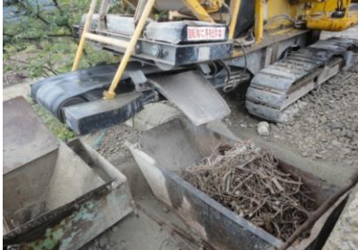
破砕処理(サイズの振分け) 右側がオーバーサイズ
