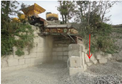
破砕処理(サイズの振分け) 右側がオーバーサイズ
