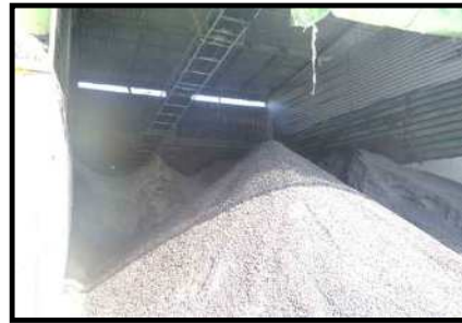
再生骨材の出口
