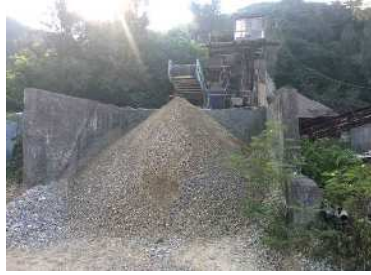
RC-40 (コンクリート)
