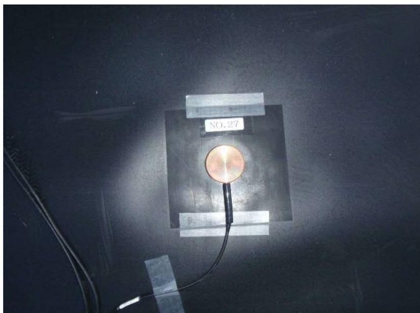
写真 1 漏水検知システムの測定電極
