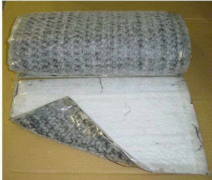
写真3 自己修復材（GCL；厚さ6mm）
