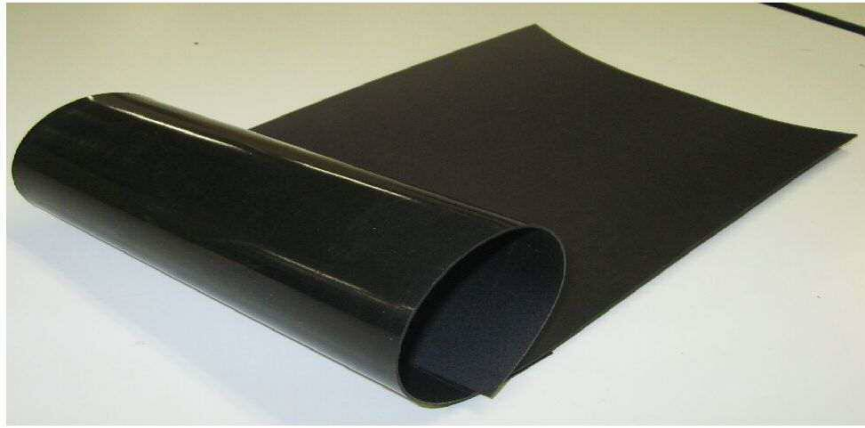
写真2 遮水シート（メタロセン系遮水シート；厚さ=1.5mm）
