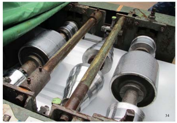
覆蓋施設・折板屋根製作
