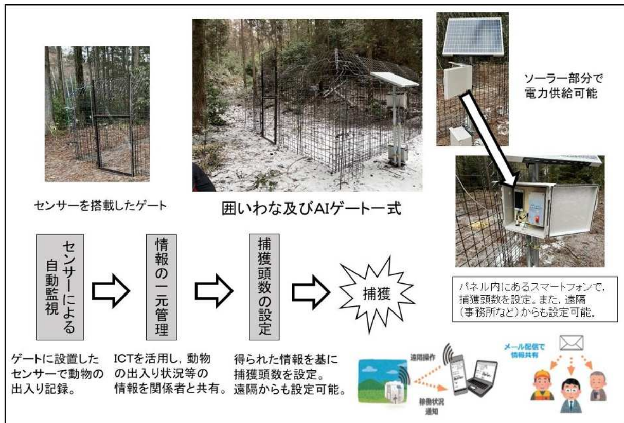
図1 囲いわな及びA I ゲートの設置状況と捕獲に至るまでのフロー
