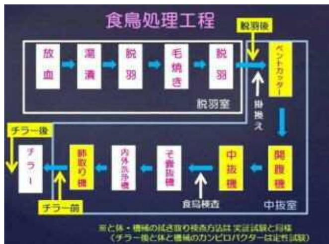
図3 食鳥処理工程
