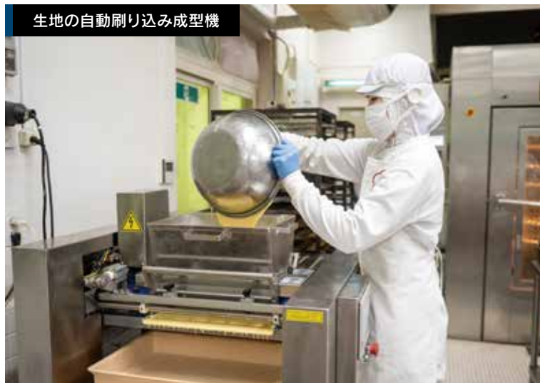
「湯之元せんべい」の刷り込み工程を、手作業から機械化。
