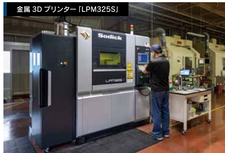
CAD/CAM データをもとに、金属粉末からフィンガーを造型できる。
