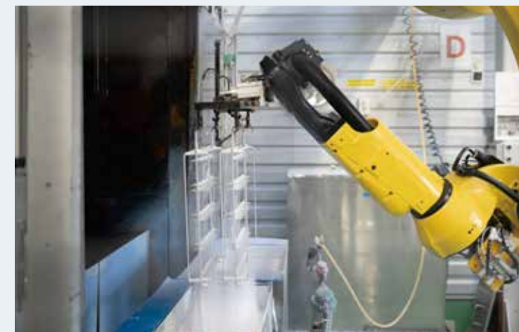
ロボットアームの動きは熟練作業者に近い。一定の力加減で粉を付ける。
