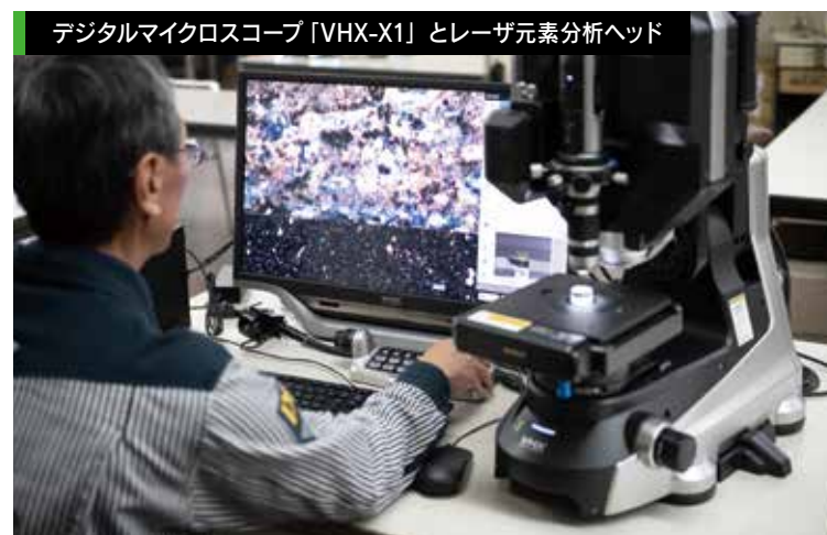
異なる金属がどのように溶融しているか、組織の様子がわかる。
