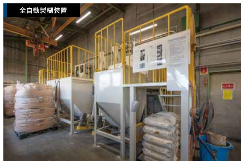
材料は大きなタンクから自動で攪拌機に送り込まれる。
