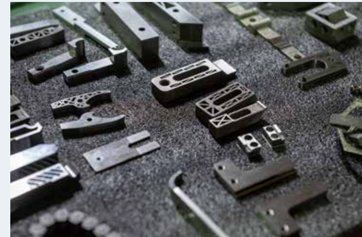
金属 3D プリンターによる試作品。動く仕組みも含めて、一体で造型できる。
