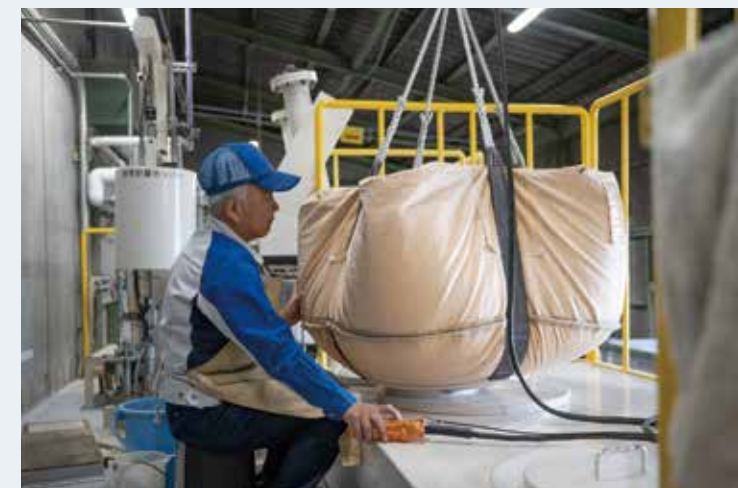
材料のタンクへの補充はクレーンで行い、力仕事から解放された。
