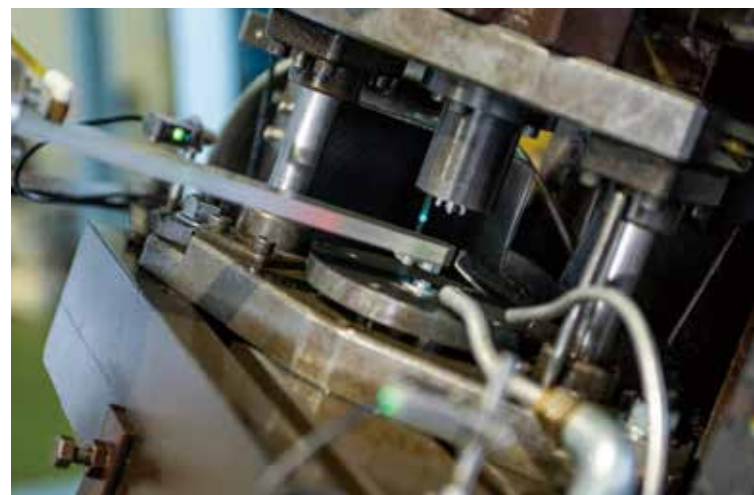
スパイクピンは、プレス機によって打ち抜きされる。
