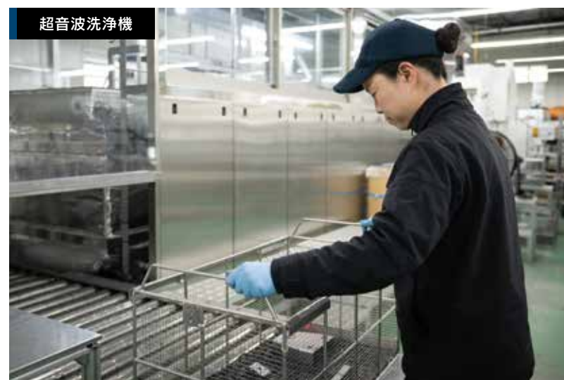
製品をカゴに入れてセット。自動で洗浄槽に送り込まれる。
