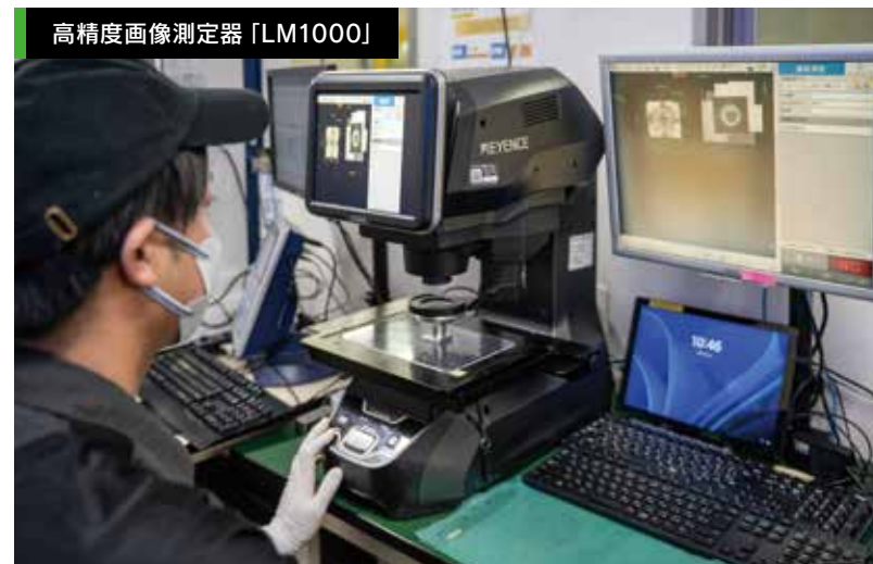
製品を置いてボタンを押すだけで、高精度の寸法測定を一瞬で完了。
