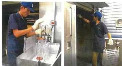
半導体部品用メッキ治具の生産工程において、樹脂コーティングを施す工程は、製品ハンドリングの難しさと樹脂の溶着厚みの均一性が品質上重要であり、限られた熟練者の経験に依存しており、多能工化が遅れている。
