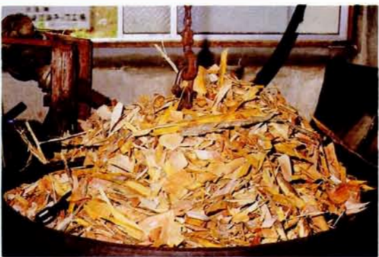
テーチ木を砕いてチップにし、釜にいれて煮つめ、染める液をつくる。
