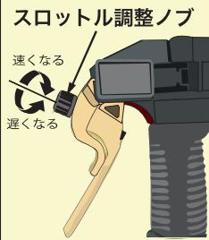
握り締めた時の刃刃回転速度上限を調整するためにスロットル調整ノブを回し、握りしろを規制します。
