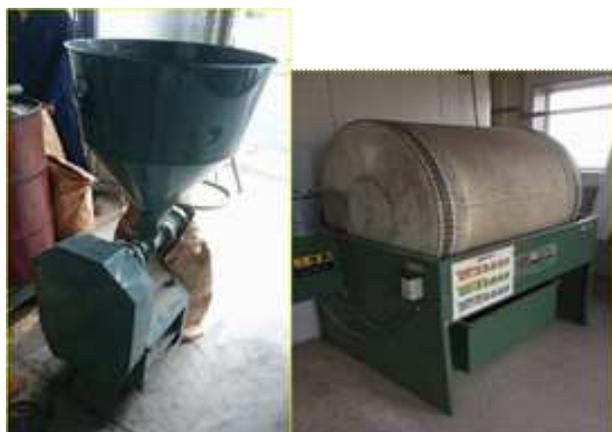
図2 玄米の破砕機（左）と飼料攪拌機（右）
