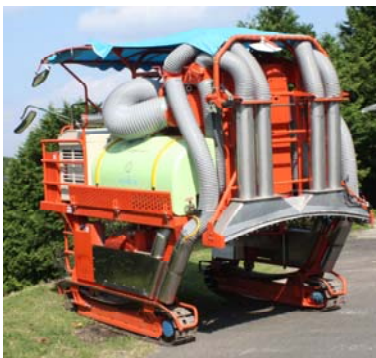
図1 サイクロン式吸引洗浄装置とその概略図
