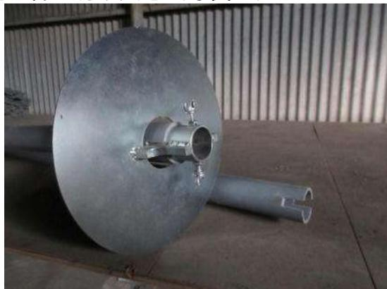
写真9 切り欠き塩ビ管と固定キー
