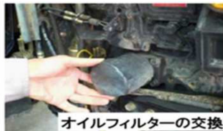
図1 エンジンの保守点検の例（トラクター、コンバイン等）
