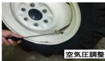
図2 走行部の保守点検の例（トラクター、コンバイン等）
