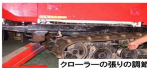
図2 走行部の保守点検の例（トラクター、コンバイン等）
