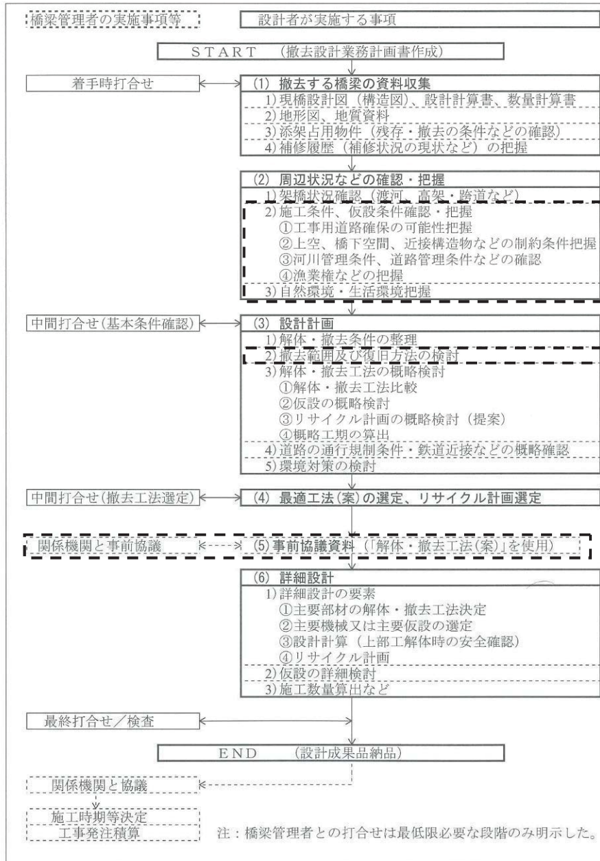
図 4.5.10-1 橋梁撤去の基本フロー
