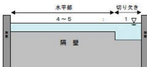
図4.7.3-9 隔壁部の切り欠き
