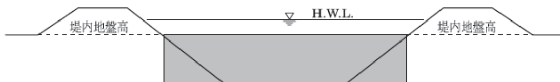
図 4.6.3-4 流下物により倒伏が妨げられない場合
