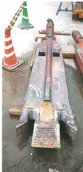
イコスピット (先行ボーリングによりカッタードラムの爪がかりを良くする)
