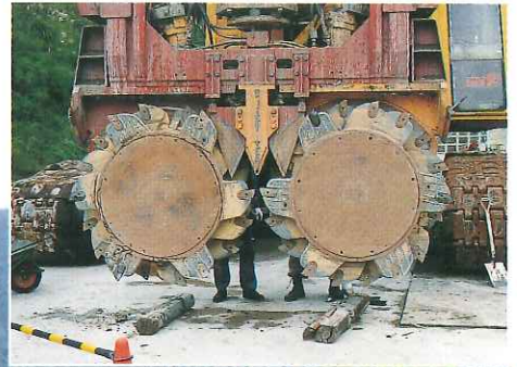
カッタードラム(爪はダイヤモンド製)
