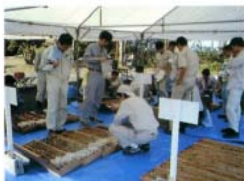
ボーリングコア確認
