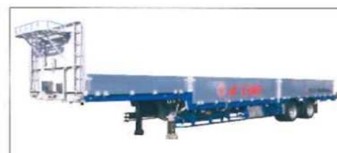
■12m段落ちトレーラー 内寸(LWH mm):12,865×2,380×1,100
