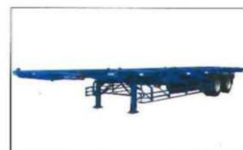
■40Fコンテナ台車 内寸(LWH mm):12,590×2,490
