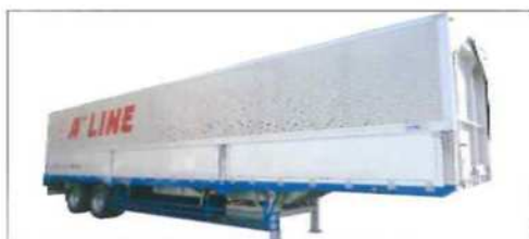
■12mウイングトレーラー 内寸(LWH mm):12,550×2,380×2,310
