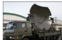
0H多重通信装置
