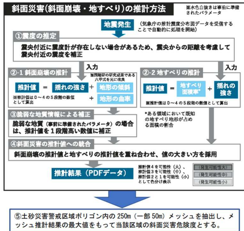
DEMを用いた斜面崩壊危険度判定のフロー (山梨県 2023)
