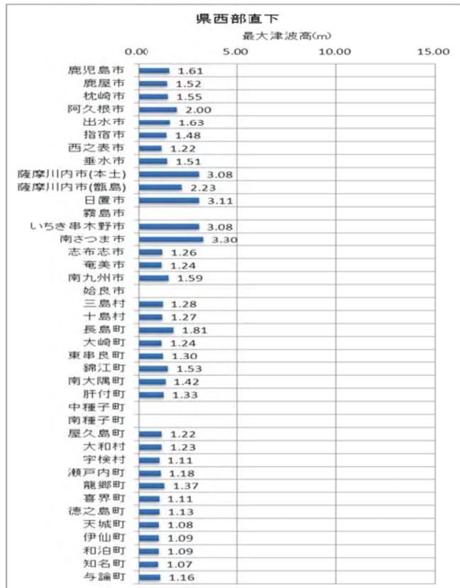
図 3.2-4 ②県西部直下の地震に伴う津波の津波高分布図
