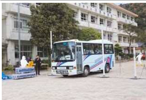
車両用ゲートモニタによる汚染検査
