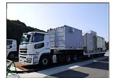
中容量発電機車
