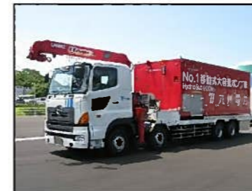
移動式大容量ポンプ車
