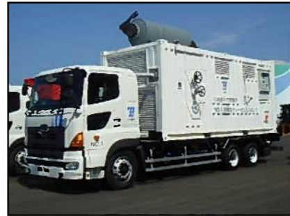
可搬型ディーゼル注入ポンプ
