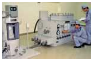
放射線を監視する装置の点検や調整試験等の訓練状況
