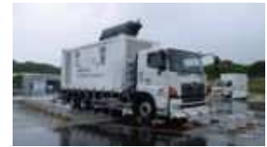
①可搬型ディーゼル注入ポンプ
