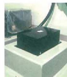
川内原子力発電所内岩盤上(建屋地下5階)の地震計(九州電力設置)
