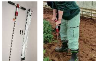
写真1 簡易型貫入式土壤硬度計 写真2 土壤硬度調査の様子
