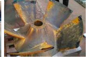
排水機場(羽根車の劣化)
