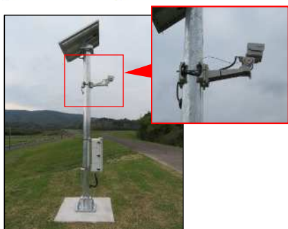
簡易型河川監視カメラ
