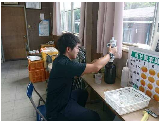
写真10 ハウスみかんの酸度滴定
