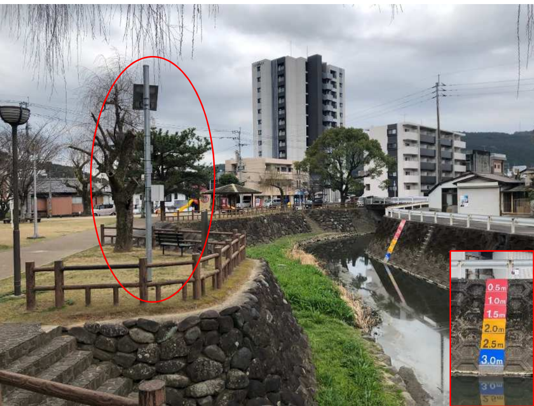
簡易型河川監視カメラ（春田川）
