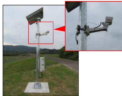
簡易型河川監視カメラ
