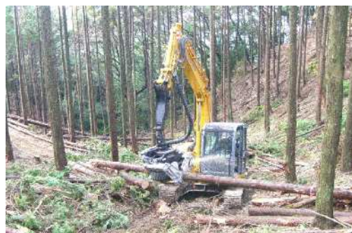
高性能林業機械による間伐作業
