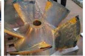
排水機場(羽根車の劣化)
