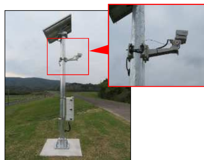
簡易型河川監視カメラ
