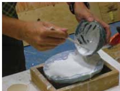
図4 水に溶いた石こうの流し込み
