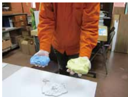
図2 印象剤(パテタイプ)による型どり
