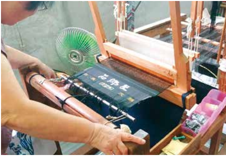
30を超える多くの工程を経て作られる大島紬。写真は「織り」の作業を行う様子
