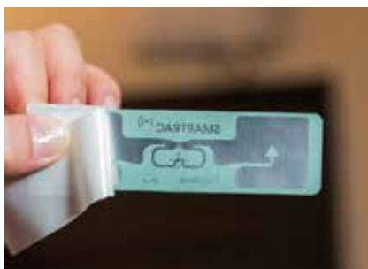
RFIDとは、世界最小クラスのタグから情報を読み書きするシステム。国内でもさまざまな分野で導入が進んでいる。
