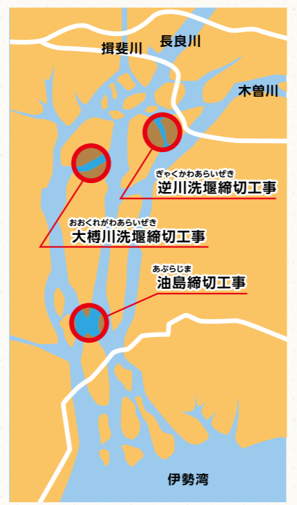
【逆川洗堰締切工事】木曾川から長良川に一気に流れ込み、氾濫しやすい場所であった。洗堰は長さ18m、高さ3m。 【大樽川洗堰締切工事】増水時に長良川から大樽川に流れ込む水量を抑える目的で築かれた。別名「薩摩堰」。 【油島締切工事】堤の長さは約1km。舟に石を積んで運び、舟ごと沈める、ということを繰り返して造られた。
