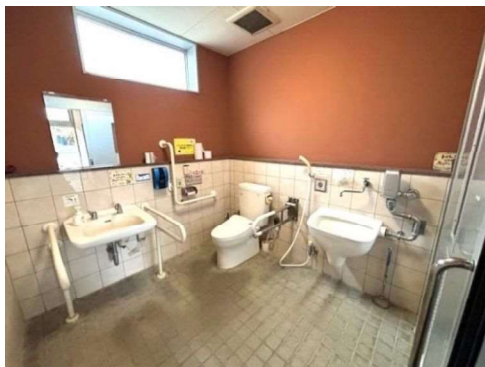
車いす対応トイレ
