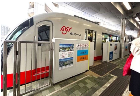
県庁前駅に停車するモノレール車両 車いす等の待機スペースがある車両入口には段差を解消するスロープが見られる
